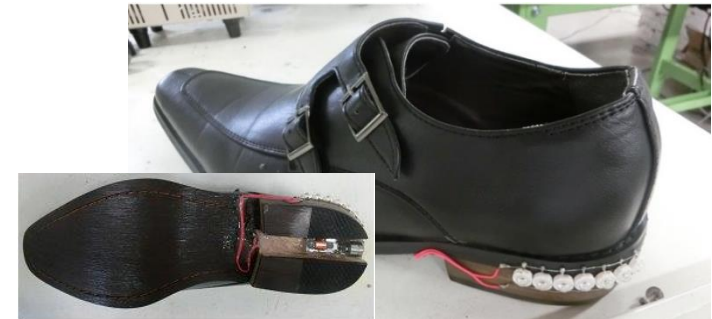
踵の衝撃でLEDが点滅するデモ 一步毎に無線通信も可能(実証済み)
